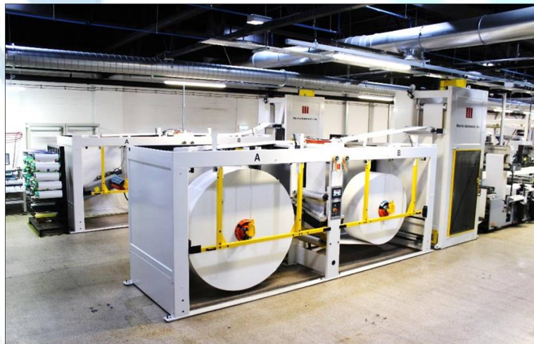
馬汀自動科技的放卷機 MBX 以及 MBSF 提供 Reflex Labels 多種材料的不停機放卷方案
